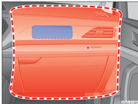
图 34 副驾驶员前部安全气囊的安装位置和膨胀范围
